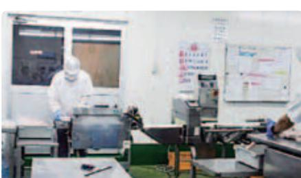
めかじきは重量検査後、金属探知機を通して出荷される
